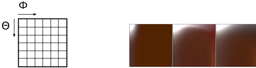
FIGURE 10 – Dump d’un matériau. Le \Theta représente l’angle de vue par rapport au matériau. Le \Phi représente l’angle de la lumière incidente. À droite, une image similaire qui est la représentation MERL-100 d’une BRDF. Ces images représente l’évaluation de la BRDF pour des angles de vue et de lumière donnés.
